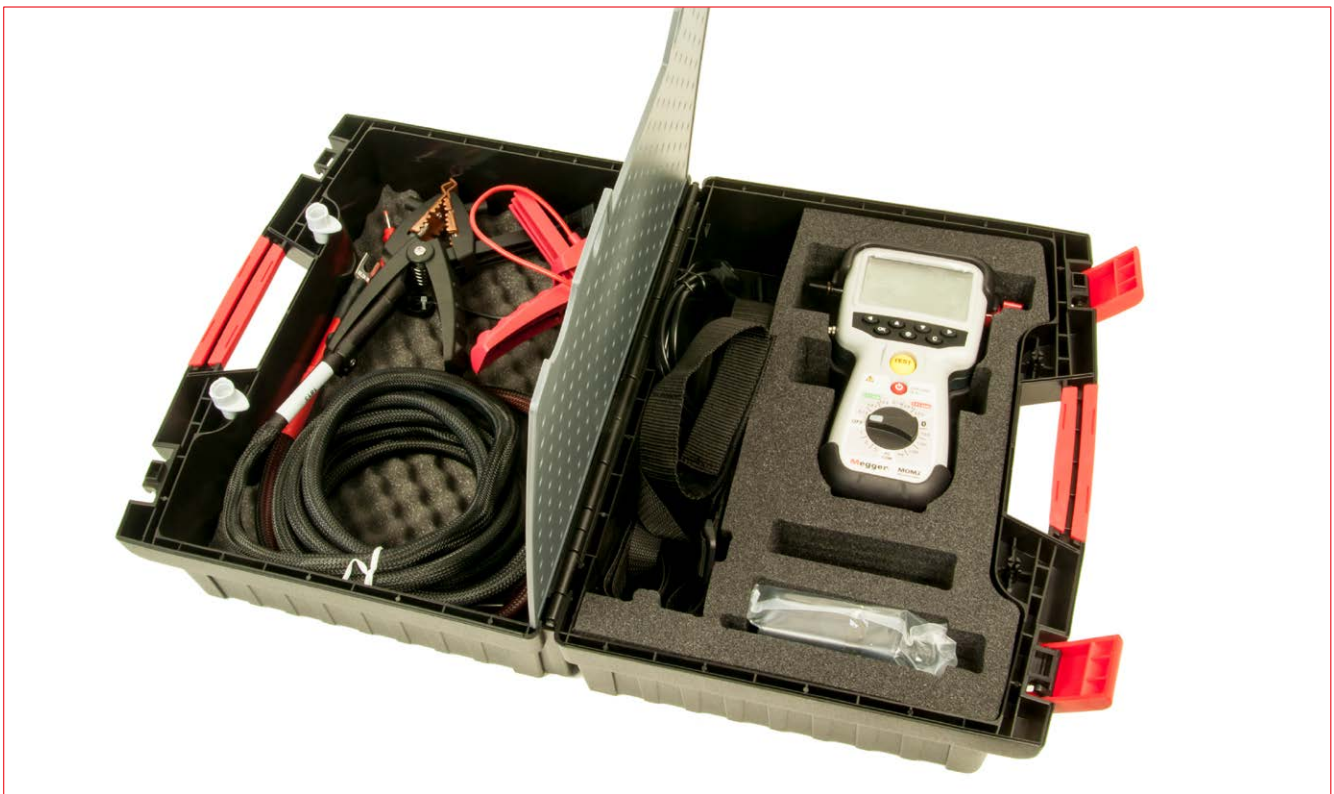
MOM2 (BD-59092) mit Transportkoffer, Ladegerät, Kelvin-Klemmen, Gummiholster, Tragegurt, Gürtelclip, MOM2 Win.
