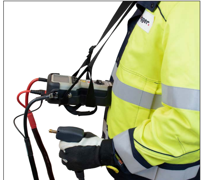
Tragegurt, der die Arbeit beim Messen mit zwei Prüfspitzen erleichtert. Im Lieferumfang des Geräts.
