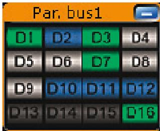
Die Signalaktivität der digitalen Kanäle wird im Signal-Icon unabhängig von den Einstellungen des Oszilloskops dargestellt.
