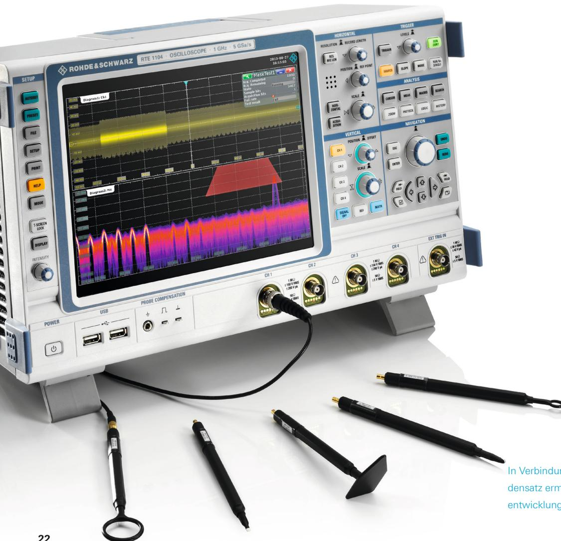
In Verbindung mit dem R&S®HZ-15 Nahfeldsondensatz ermöglichen die R&S®RTE Oszilloskope entwicklungsbegleitende EMV-Tests.
