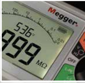
Der Analogbogen simuliert das Verhalten einer mechanischen Messnadelanzeige
