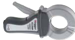
1001-012 (ICLAMP) Stromzange (Öffnung 54 mm) zur Messung von Leck- und Ableitströmen von 0,1 mA bis max. 200 A, sowie als Messzange zur selektiven bzw. zur spießlosen Erdungsmessung induzierende Stromzange
