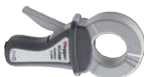
1001-012 (ICLAMP) Stromzange (Öffnung 54 mm) zur Messung von Leck- und Ableitströmen von 0,1 mA bis max. 200 A, sowie als Messzange zur selektiven bzw. zur spießlosen Erdungsmessung
